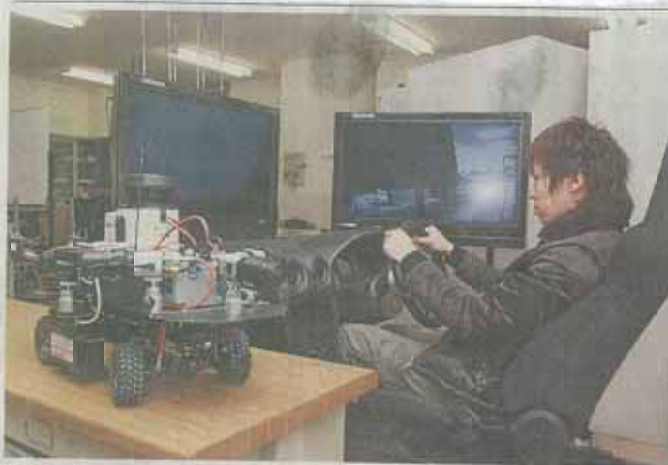
無線操縦カー（手前）の送る映像を見ながら運転を体験できるシミュレーション装置
