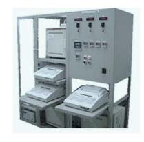
製品名 触媒反応装置 検出器 熱伝導度検出器
