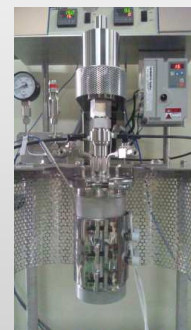
○オプション装着例 圧力計、熱電対、安全弁 高圧攪拌機 バンドヒーター+温調器
