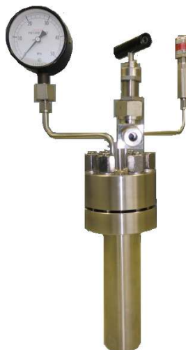
○内容積: 75cc ○圧力: 30MPa ○使用最高温度: 500℃ ○オプション: ニードル/圧力計、安全弁
